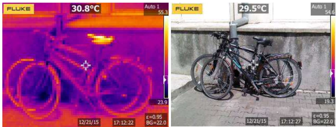
Figura 5 Imagini termografică și optice a unei biciclete din parcare UTCN B-dul Muncii obținute cu camera de termoviziune Fluke TiS10
