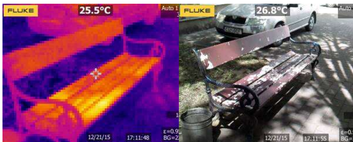
Figura 3 Imagini termografică și optice a unei bănci din parcare UTCN B-dul Muncii obținute cu camera de termoviziune Fluke TiS10
